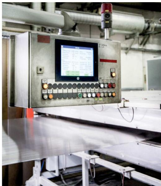
Beim Auftragen des UV-Schutzes auf die Polycarbonat-Platten **informiert die Anzeige am QuickPanel Display** u. a. über die Geschwindigkeiten, mit denen sich die Auftrags- und Dosierwalzen bewegen.
